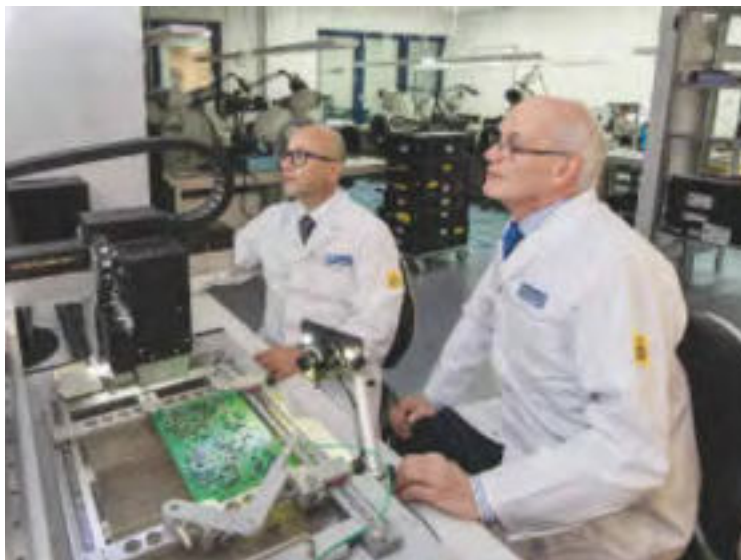
Automatisiertes Reworken mit Ersa HR 600/2.
